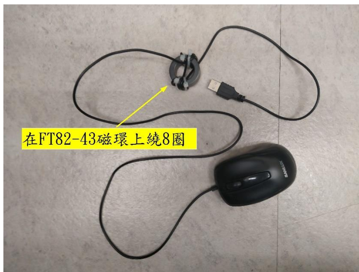
圖_33: 將滑鼠纜線在鐵氧磁環 FT-82-43 上繞 8 圈
