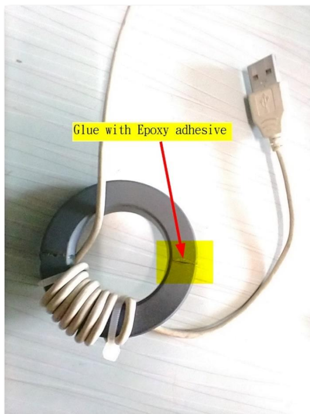
圖 32: 滑鼠纜線繞在磁環上
