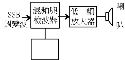
(2) 33. 頻率 $f$ 的輸入信號與頻率 $f_0$ 之本地振盪器的輸出以混頻器混合時，通過輸出端電流的頻率為下列何者？
